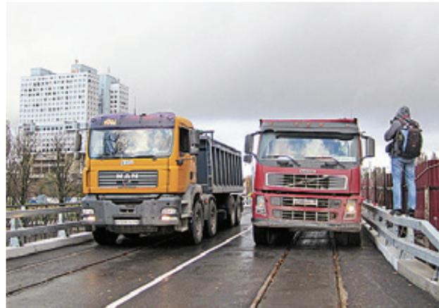
■ Испытание Деревянного моста провели с помощью грузовых машин
